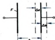
Bild 2. Prinzip des Meßkondensators mit Abstandsänderung
